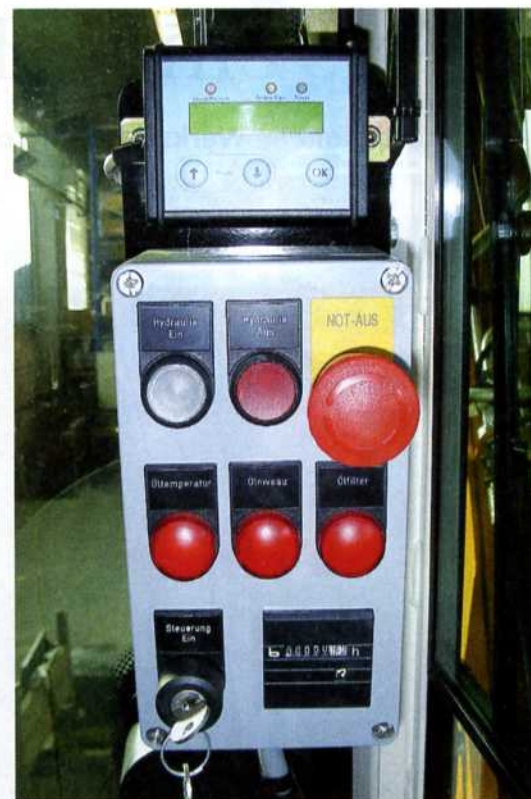
Bedienung des Hydraulikaggregats in der Baggerkabine
