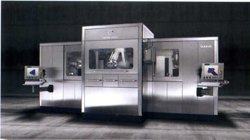
Bild 1: Das Maschinengehäuse ist von dem Edelstahl-Blechexperten Hubl GmbH konstruiert und gefertigt worden
