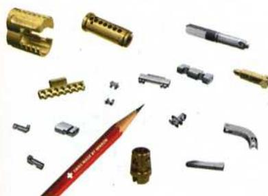
Der besondere Kniff dabei ist, dass die Wirtschaftlichkeit bei den Systemen des Typs NAD bereits bei Losgrößen unter 50 Stück beginnt und bis zu mehreren tausend Auflage reicht. Gängige Werkstoffe sind Stahl, Messing, Titan
