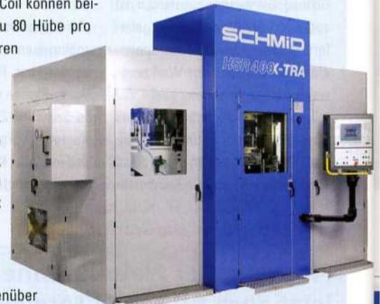
werden. Die Hubzahlen gegenüber dem Vorgängermodell liegen somit um 50% höher, so der Hersteller. Jeder Bearbeitungsschritt kann dabei im Hub seine eigene, optimale Geschwindigkeit fahren. Mit der neuen Feinschneidpresse schließt der Hersteller die Lücke zwischen den Modellen mit 3200 und 6300 kN Presskraft. In einem Arbeitsgang entstehen feinschnittene, präzise Werkstücke
