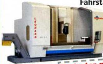
Remacontrol hat sich auf die Konstruktion und Herstellung von Fahrständer-Bearbeitungszentren spezialisiert. Das Angebot umfasst Maschinen mit Verfahrbereichen der X-Achse bis zu 8.000 mm und Y/Z-Achse bis zu 1.000 mm, 3-Achsen, optional 4 und 5 Seiten Bearbeitung.
