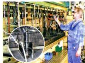
Sie werden von Hand am Werkzeugrand positioniert, spannen mit hydraulischem Druck, lösen durch Federkraft und erreichen Spannkräfte zwischen 60 und 200 kN. Neu ist eine Variante mit frei einstellbarem und variablem Spannmaß. Dadurch ist der Hohlkolbenzylinder zum Spannen von Werkzeugen mit unterschiedlichen Spannrandhöhen einsetzbar. Die Zahl der in der Produktion benötigten Spannelemente reduziert sich und beim Anwender entfällt eine Standardisierung der Spannrandhöhen.
