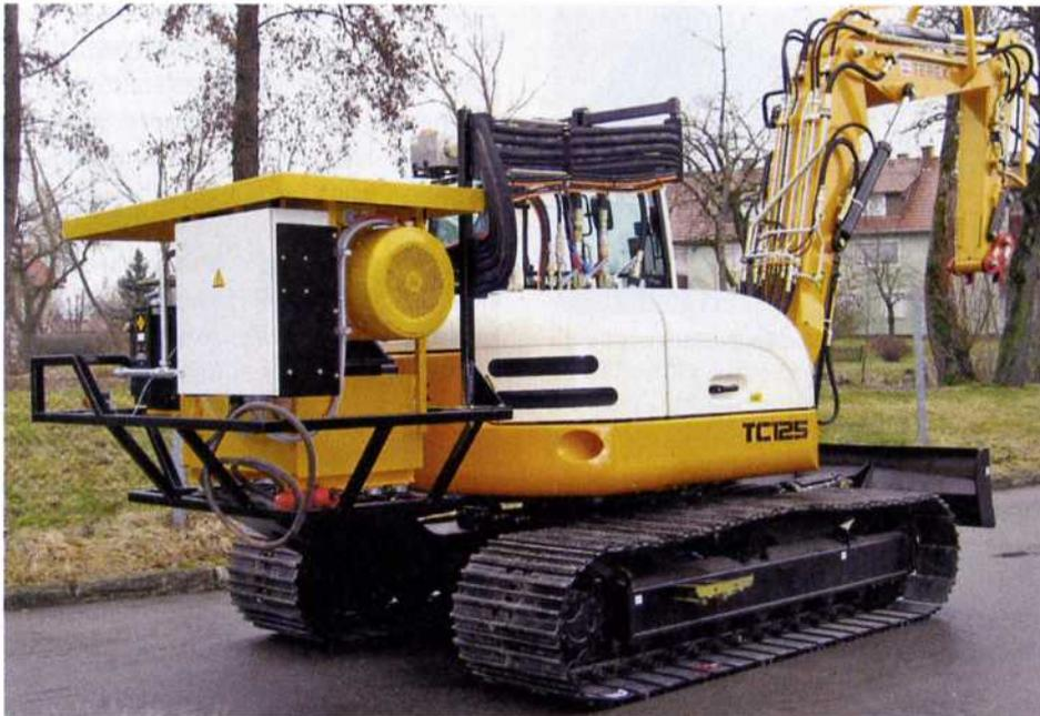
Ein leichter Raupenbagger von Terex ist durch Bott-Hydraulik fit gemacht für den Tunnelbetrieb.
