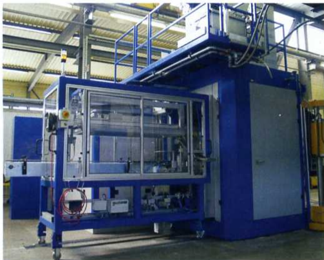
Die Handlinganlage für das automatisierte Be- und Entladen der Teile.
