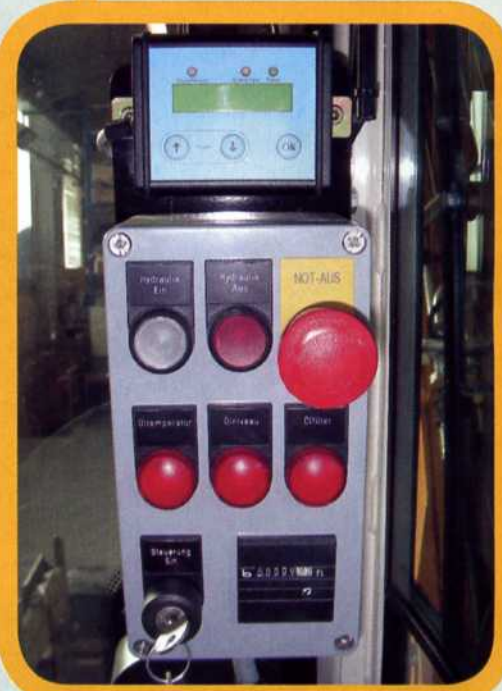
Bedienung des Hydraulikaggregats in der Baggerkabine.
