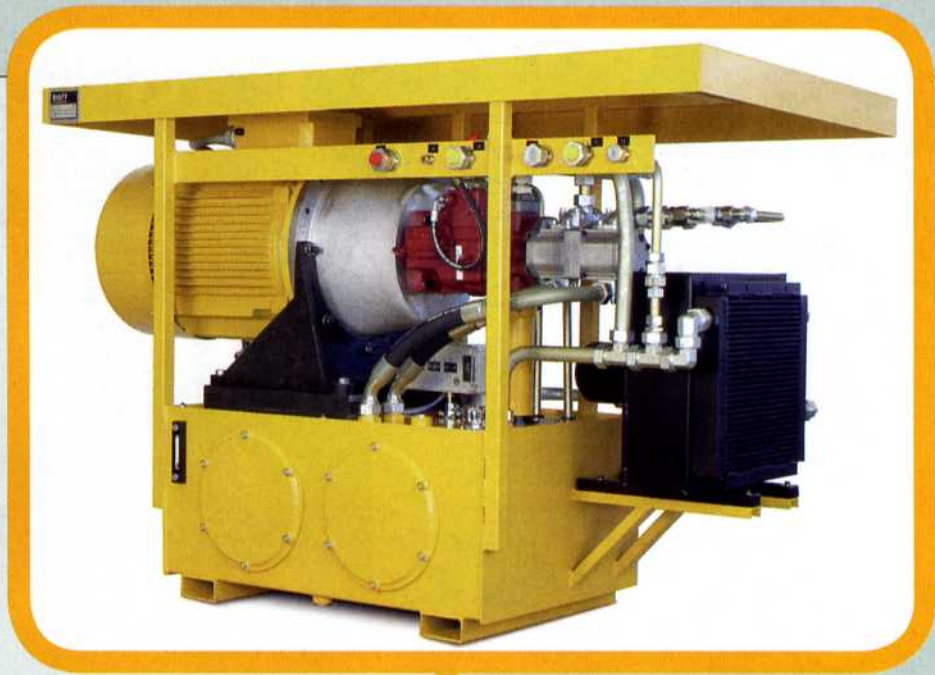
Das aufgesetzte Hydraulikaggregat mit einem 250 Liter fassenden Tank ermöglicht den Baggerbetrieb im Tunnelbereich der Amsterdamer U-Bahnhöfe.
