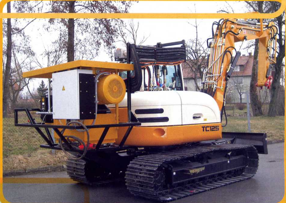
Raupenbagger der 12,5-t-Klasse: ausgestattet mit einem 960 kg schweren Hydraulikaggregat.
