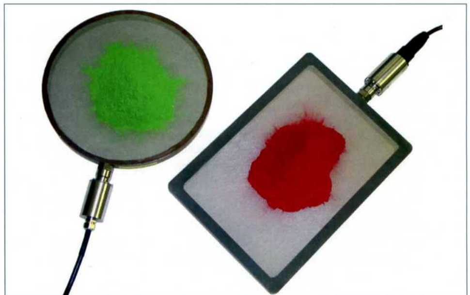
Das Ultraschall Siebsystem erlaubt eine konstante Siebabreinigung mit einem permanent hohen Durchsatz. Das Überkorn wird separiert, Stippen und Schmutzpartikel, die aus der Umgebungsluft stammen, werden abgesiebt. Agglomerate, die durch Transport oder Lagerung entstehen, werden aufgelöst oder ebenfalls abgesiebt. (Bilder: suxes)
