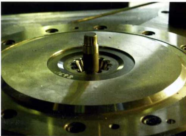
Bild 5: Die Gesenke lassen sich preisgünstig herstellen. In der Auslegung der Verzahnung steckt das Know-how der Heinrich Schmid AG
