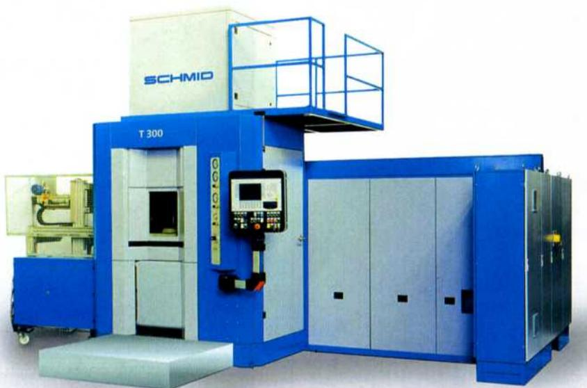
Bild 1: Mit Taumelpressen werden die Produktionsprozesse der Industrie optimal unterstützt. Extreme Massivumformung in kürzester Zeit wird mit dieser Anlage möglich
