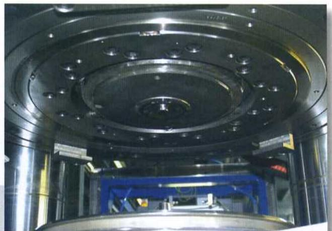
Bild 6: Das obere Gesenk der Taumelpresse taumelt kreisförmig um das Werkstück und "walzt" den Werkstoff oberflächenschoenend in das untere Gesenk
