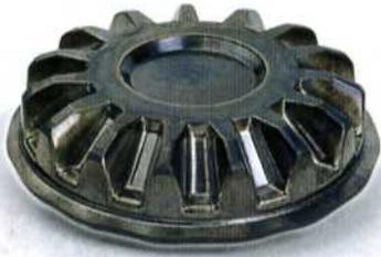
Bild 4: Kegelräder können mit dem Taumelverfahren wirtschaftlich und in hoher Oberflächengüte hergestellt werden
