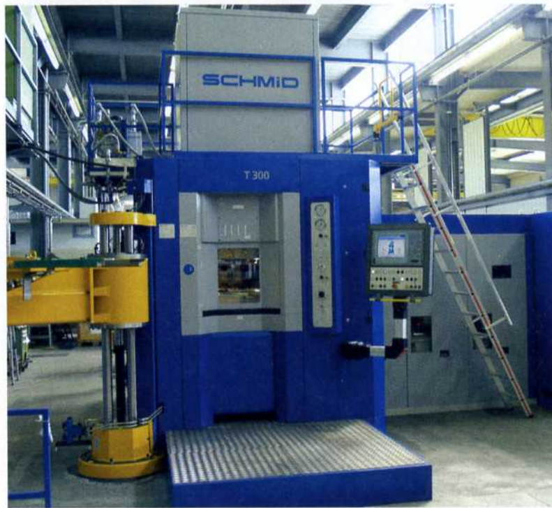
Bild 1: Inbetriebnahme der Taumelanlage für Belarus in Minsk bei der Heinrich Schmid AG in Jona.
