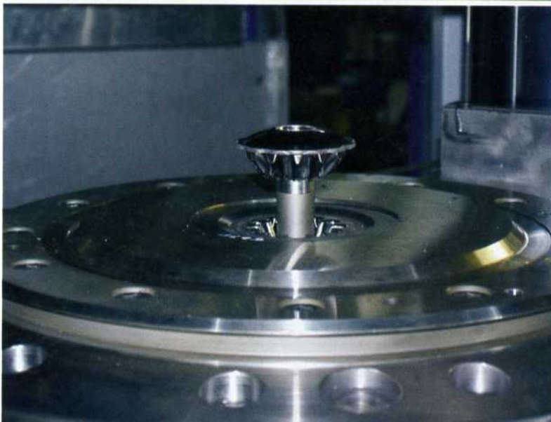
Bild 5: Nach dem Taumeln ist das Differenzialkegelrad in seiner endgültigen Form. Eine anschließende Endbearbeitung sorgt für die Einsatzfähigkeit.
