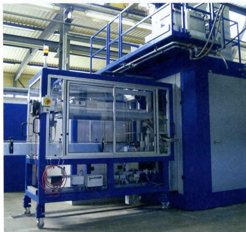
Bild 2: Die Handlingsanlage hinter der Taumelpresse sorgt für automatisiertes Be- und Entladen der Teile.
