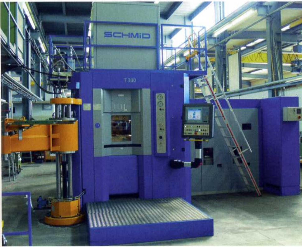
Inbetriebnahme der Taumelanlage für Belarus bei der Heinrich Schmid AG in Jona
