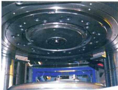
Das obere Gesenk der Taumelpresse taumelt kreisförmig um das Werkstück und walzt den Werkstoff oberflächenschonend in das untere Gesenk
