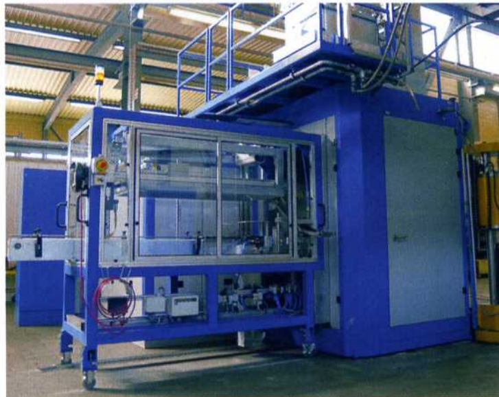
Die Handlinganlage hinter der Taumel- presse sorgt für automatisiertes Be- und Entladen der Teile
