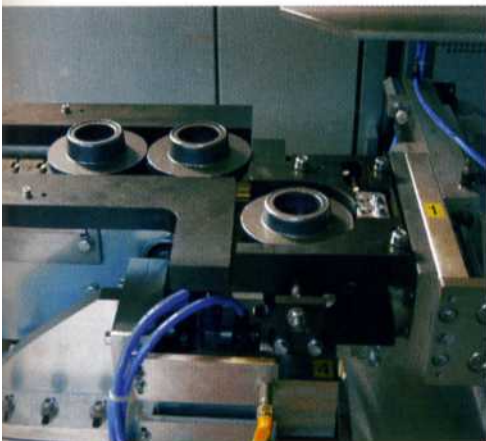
Automatische Zuführung der Schmiederohlinge
