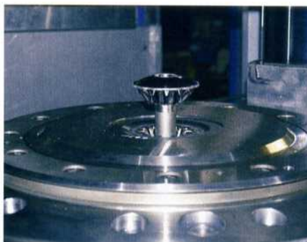
Nach dem Taumeln ist das Differentialkegelrad in seiner endgültigen Form. Anschließend Endbearbeitung macht es einsatzfähig
