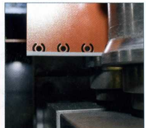
Das Umkanten von 5 mm beugt Verletzungen bei der späteren Handhabung vor.
