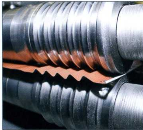
Die Rollenpaare sind aus hochlegiertem Stahl auf Präzisionsmaschinen hergestellt.
