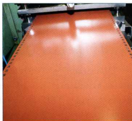
Nach dem Richten werden die zwei Lochreihen mit je 88 Löchern gestanzt.
