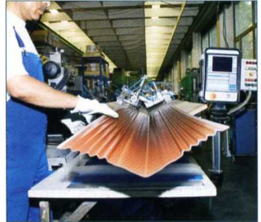
Zuletzt werden die Kehlbleche entnommen und versandfertig gestellt.
