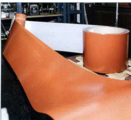
Verzinktes Stahlblech 0,5 mm stark und pulverbeschichtet ab Coil als Ausgangsmaterial.
