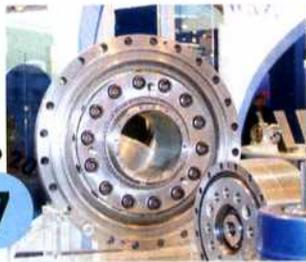
Mit der Fine-Cyclo-F2C-C- und F2F-C-Serie stellt Sumitomo Drive Technologies ein Präzisionsgetriebe mit größerer Hohlwelle vor. Die Getriebe sind komplett abgedichtet und verfügen über Hohlwellen mit Durchmessern von 49 bis 99 mm für platzsparende Kabelführungen. Die einstufigen,
