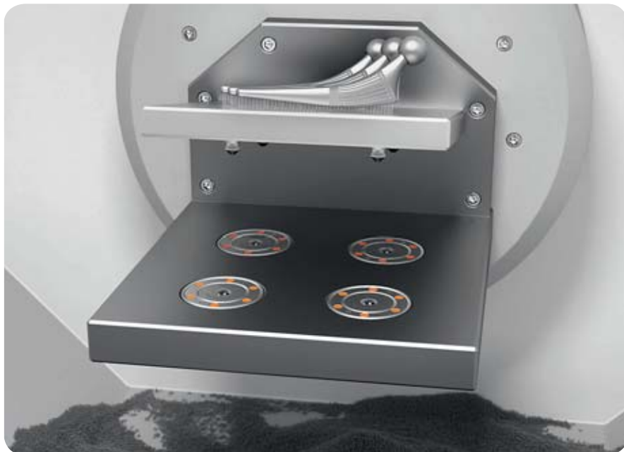
Anwender, die die AMF-Nullpunktschnittstelle in der additiven Fertigung auf Folgeprozesse, wie das Reinigen mitnehmen, senken Rüstzeiten um über 90 Prozent.
