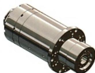
zision aus. Kenturns Einbau-Motor-spindel MVB1318A ist mit einer Kühlung der Achsen ausgestattet. Sie ist vor Wärmegang und thermischer Verformung geschützt. Dazu trägt auch das deutsche Original-Zugstangensystem OTT-HSK-A63 bei. Außerdem halten die Öl-Luft-Schmierlager anhaltenden Zerspanungsarbeiten stand. Die Motorleistung der Spindel beträgt bis zu 25 kW, während die Drehzahl 18 000 min<sup>-1</sup> erreicht.
