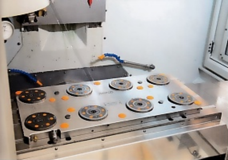
Die Spannstation von AMF mit acht eingebauten Nullpunktspannmodulen ist mit nur 36 mm Gesamthöhe extrem flach. Bild AMF
