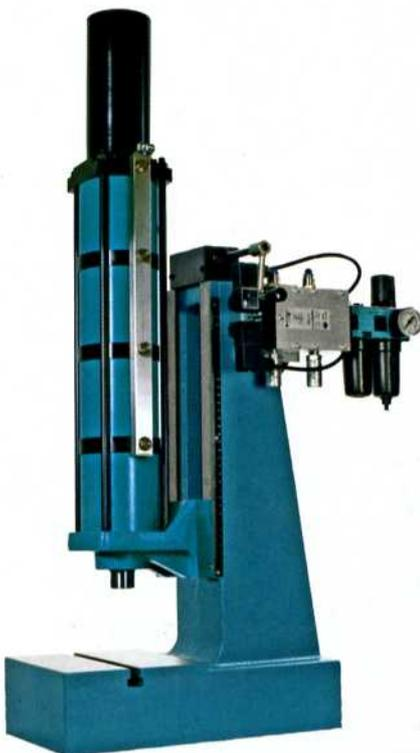
Direktwirkende Druckluftpresse mit stufenlos einstellbarem Hub.
