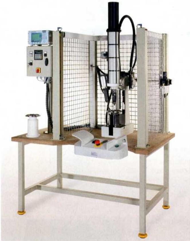
Automatisierte Einpresstation mit Prozessüberwachung für die Inline-Fertigung.
