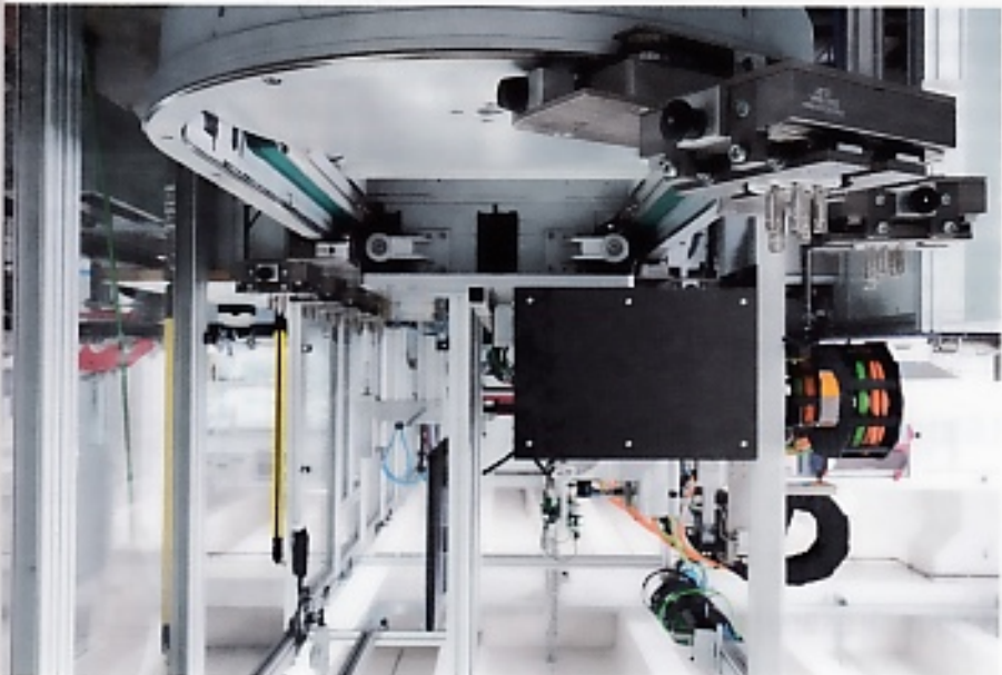
Linearmontagesystem – komplett, einbaufertig vormontiert und verdrahtet
