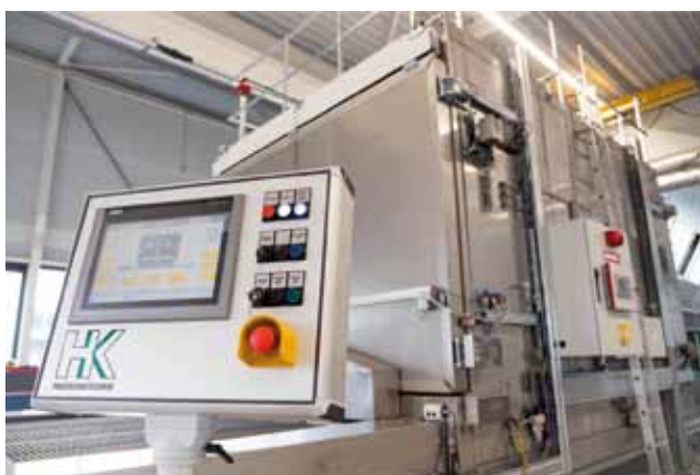
Bild 3: Die Kammern werden getrennt voneinander geregelt und überwacht. Die Steuerung enthält auch eine Überwachungs- und Trackingfunktion, die jeden, mit einem Halbzeug beladenen Rost codiert und seinen Fortgang im Ofen minutiös festhält
