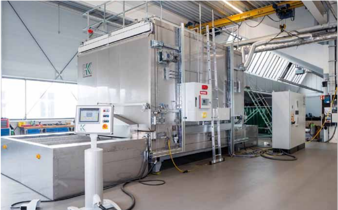
Bild 1: Für die Umformung von flächigen und vorgeformten Komposite-Halbzeugen zu Hochleistungs-Bauteilen erwärmen Umluftöfen thermoplastische Verbundwerkstoffe homogen, schonend und energiesparend
