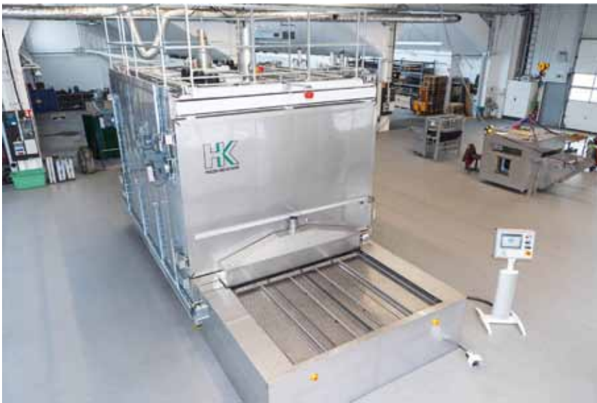
Bild 2: In den Umluftöfen werden je nach Bauhöhe des Teils bis zu 36 Aufnahmeroste, die wie Schubladen aussehen, durch zwei Kammern befördert, z.B. für Taktzeiten \leq 30 sec., bei Materialstärken von ca. 3 mm
