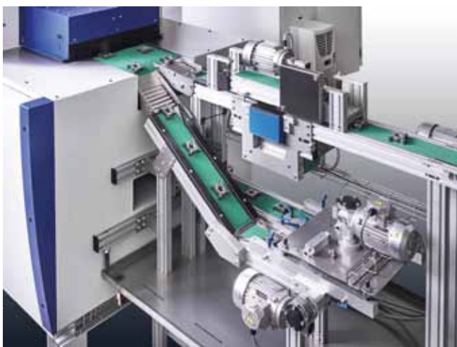
Bild 4: Durch intelligent gestaltete Umkehrschleifen können hochschlagempfindliche Werkstücke beidseitig entgratet werden (Werkbilder: Surfinsys AG, CH-Lichtensteig)
