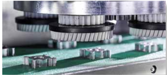
Bild 2: Die planetaren Bürsten werden mittels Zahnräder ohne zusätzliches Getriebe direkt über das zentrale Aggregat angetrieben
