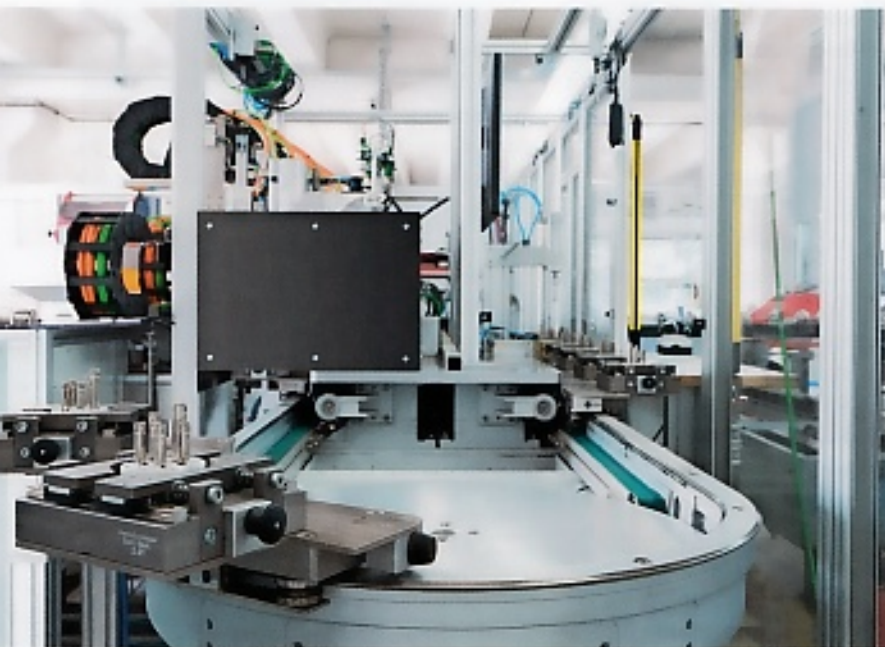
Beim Sondermaschinenbauer Wilei laufen Werkstückträgertransport und Handling in der Montagestraße komplett automatisiert ab. Bilder: Weiss
