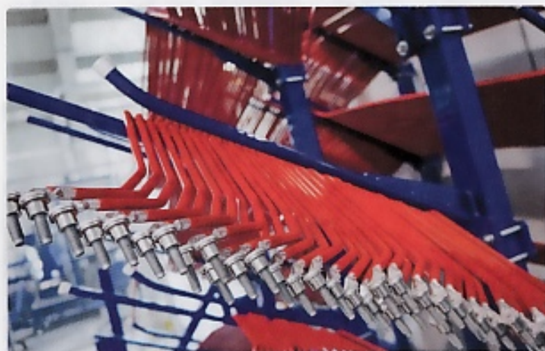
Bild 1: Um Gewicht und Kosten zu sparen, wird die Energieverteilung im Auto Zug um Zug auf Aluminiumleiter umgestellt
