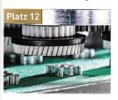
Die Maschinen entfernen Grate, die beim Stanzen, Sintern ader Feinschneiden entstehen, wie es in einer Unternehmensmitteilung heißt. Erste Maschine der neuen Familie, die sich zwischen Basis- und High-End-Maschinen des Herstellers einreihen, ist die Surfinsys DA300P. Sie arbeitet, wie es heißt, mit zwei Aggregaten, auf denen je fünf Schleifbürsten mit 150 mm Durchmesser integriert sind. Die planetaren Bürsten werden direkt über das zentrale Aggregat angetrieben.
