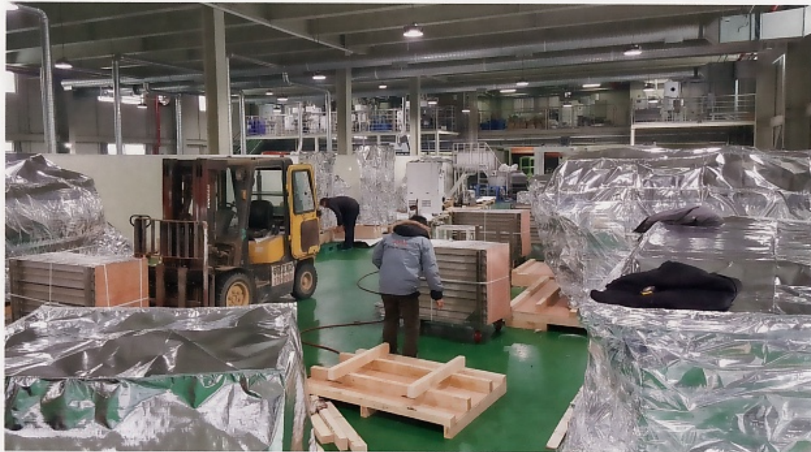
Eine der größten Herausforderungen waren die beengten Räumlichkeiten, denn demontierte Anlagen nehmen, ähnlich wie auseinandergebaute Möbelstücke, deutlich mehr Fläche ein als montierte.
