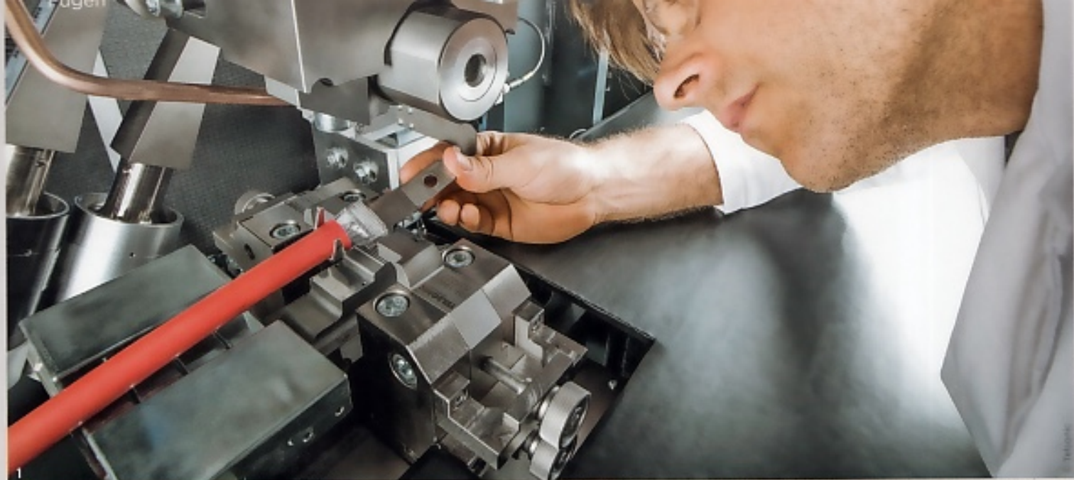
1 Mit dem Telsonic-Powerwheel-Verfahren schweißt Julian Electric kraftvoll und sicher im Serienprozess Leitungen für schwere Nutzfahrzeuge.
