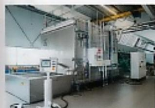
**Kunststofftechnik** - *pt.* Wer flächige Compositehalbzeuge verarbeitet, nutzt in der Regel Öfen für die Vorwärmung seiner Bauteile, wie HK Präzisionstechnik sagt. Weit verbreitet seien Infrarotsysteme, die aber bei den immer häufiger genutzten Hybridbauteilen an ihre Grenzen
