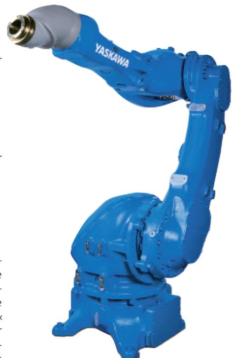
**Der Lackierroboter »Motoman MPX2600« von YASKAWA eignet sich besonders gut für Beschichtungsanwendungen wie das Lackieren von Kleinstteilen.**
