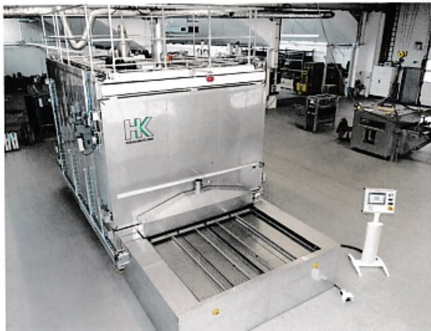
▲ In den Umluftöfen werden je nach Bauhöhe des Composite-Teils bis zu 36 Aufnahmeroste, die wie Schubladen aussehen, durch zwei Heizkammern befördert. Bei Teilen mit Materialstärken von etwa 3 mm lassen sich Taktzeiten von 30 Sekunden oder weniger erreichen.
