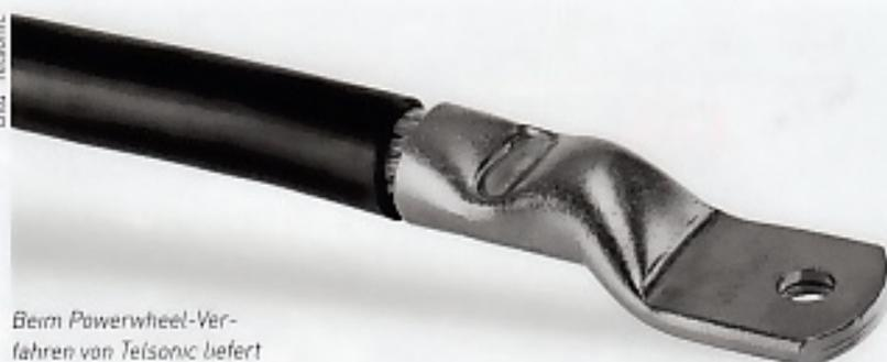
Beim Powerwheel-Verfahren von Telsonic liefert eine Standardmaschine bis zu 10 kW Schweißleistung bei maximalen 8 kN Kraft, ohne dass dabei die sonst üblichen Probleme mit dem Frequenzsprung auftreten. So können auch große Flächen und Kabeldurchmesser geschweißt werden.
