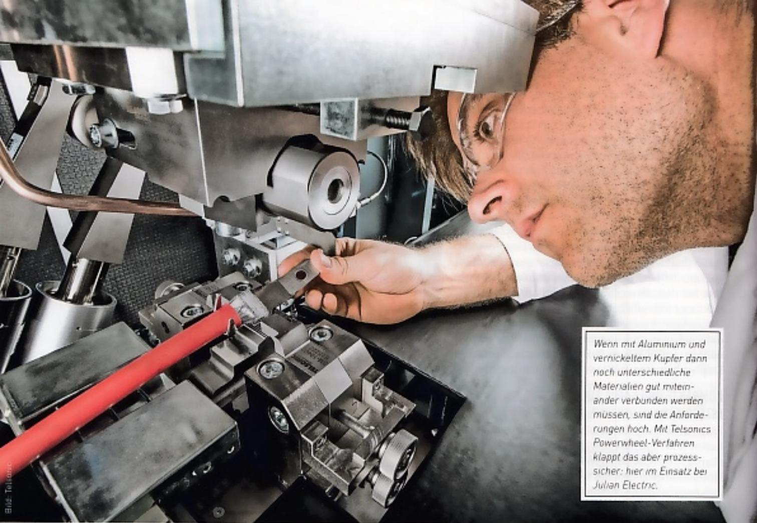
Wenn mit Aluminium und vernickeltem Kupfer dann noch unterschiedliche Materialien gut miteinander verbunden werden müssen, sind die Anforderungen hoch. Mit Telsonic Powerwheel-Verfahren klappt das aber prozesssicher: hier im Einsatz bei Julian Electric.
