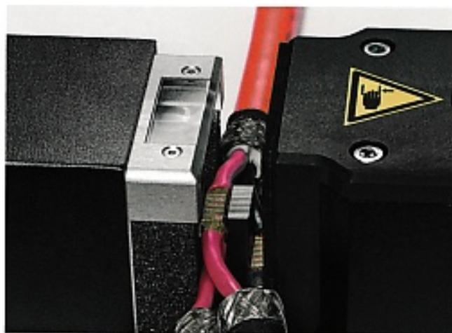
Bild 1: Beim Ultraschallschweißen entstehen hochfeste Verbindungen mit sehr guter elektrischer Leitfähigkeit. © Telsonic
