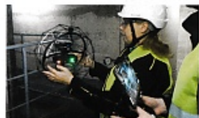
Mit der Drohne lassen sich Inspektionen in Industrieanlagen durchführen. Selbst die Inneninspektion eines Tanks ist damit möglich. Seite 9
