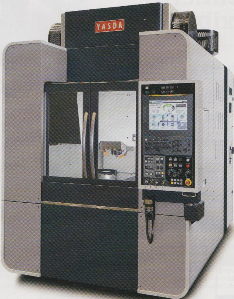
Die YMC 650 basiert auf den Baugruppen der YMC 430 mit geänderter Achsanordnung, größerem Bearbeitungskubus und Linearantrieben in allen Achsen.
