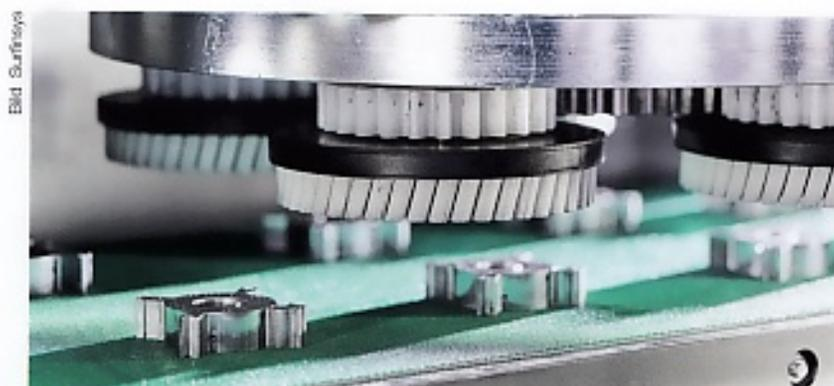
Die planetaren Bürsten werden mittels Zahnrädern ohne zusätzliches Getriebe direkt über das zentrale Aggregat angetrieben.
