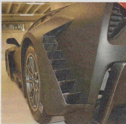
Wie sehr die Produkte gerade auch im Composites-Leichtbau zum Einsatz kommen, machte ein hausinternes Symposium deutlich mit Exponaten aus unterschiedlichen Industriezweigen. Das Foto etwa zeigt ein Detail einer 600 PS starken Corvette C7 GT3-R mit zahlreichen Composite-Teilen, mit der das Team Callaway Competition die Fahrer- und Teamwertung der diesjährigen ADAC GT Masters gewonnen hat. ●
