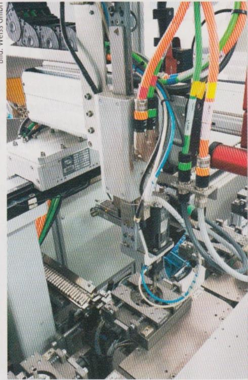
Eine Kombination aus einer HG-25- und HL-50-Linearmotorachse sowie einem ST-55-Drehmodul greift die Steckerstifte bzw. Hülsen und setzt sie in die Halteplatte der CEE-Steckverbindung ein.
