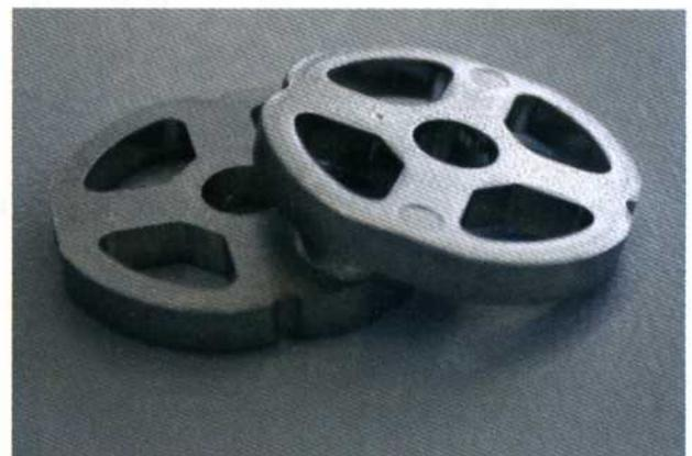
**Bild 3:** Beidseitig bearbeitete Teile für Elektromotoren. Der Maschinendurchsatz beträgt 18 000 Stück in der Stunde. Bei diesen Teilen ist ein Wende- und Rückführsystem installiert.
