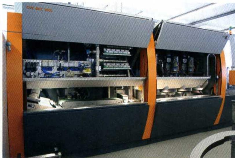
**Bild 1:** Modular aufgebaute Maschine zum Schleifen, Entgraten und Fräsen von Massenteilen. Der Durchsatz beträgt bis zu 30 000 Stück in der Stunde.
