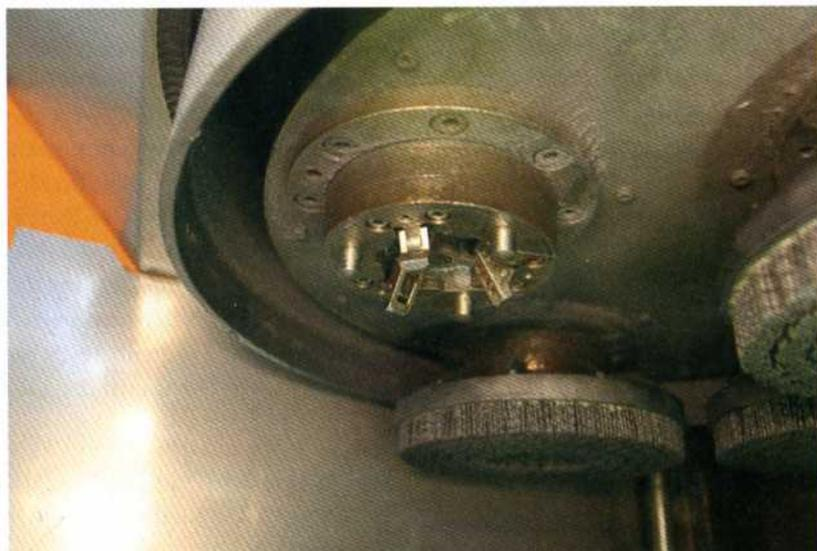
Bild 5: Ein pneumatisches Spannsystem mit Fußschalter erleichtert den Werkzeugwechsel bei allen vier Prozess-Schritten.
