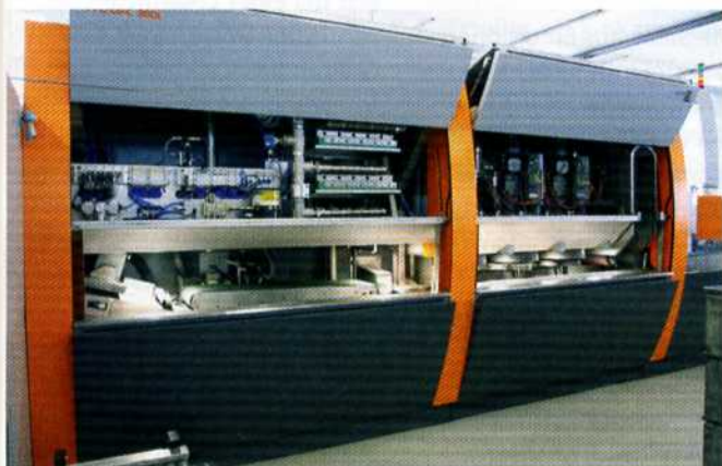
Die modular aufgebauten Aggregate erlauben das Schleifen, Entgraten und Fräsen von bis zu 30 000 Teilen in der Stunde
