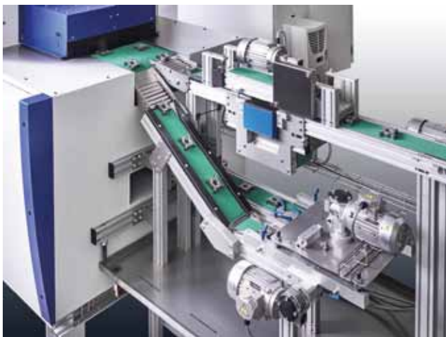
Bild 4: Durch intelligent gestaltete Umkehrschleifen können hochschlagempfindliche Werkstücke beidseitig entgratet werden (Werkbilder: Surfinsys AG, CH-Lichtensteig)
