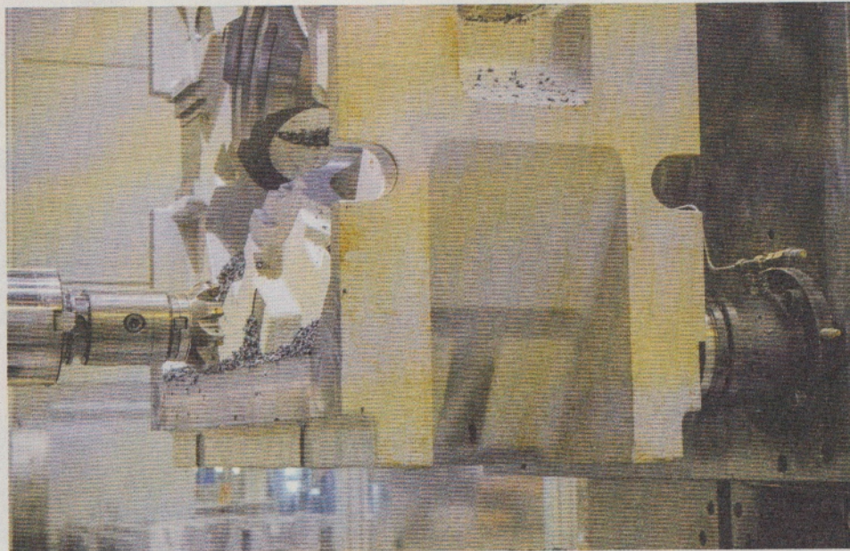
Die extrastarken AMF-Module K40-H realisieren bei einem Durchmesser von 148 mm 40 kN Einzugs-/Verschlusskräfte sowie 105 kN Haltekraft.
