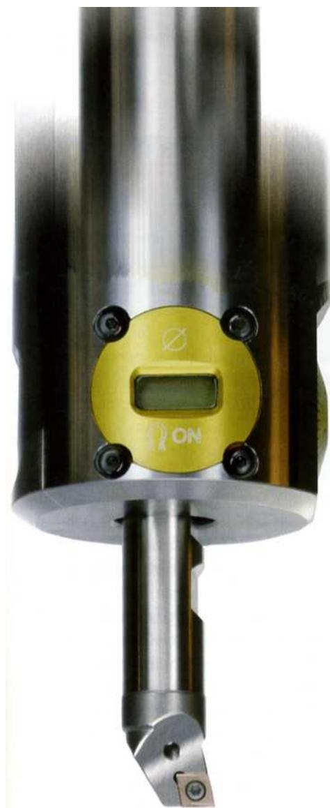
**Der neue Feinbohrkopf von Swiss Tools Systems lässt sich in Mikrometer-Schritten ohne Umkehrspiel einstellen**
