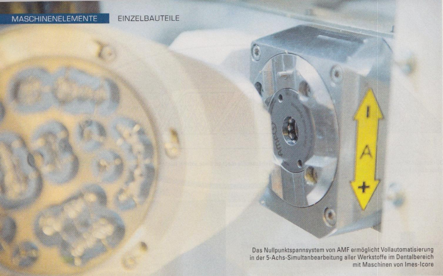
Das Nullpunktspannsystem von AMF ermöglicht Vollautomatisierung in der 5-Achs-Simultanbearbeitung aller Werkstoffe im Dentalbereich mit Maschinen von Imes-Icore
