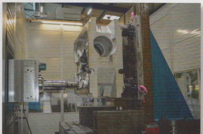
Bild 2: Auf dem riesigen Union Bohrerwerk für die Schwerzerspannung kommen die extrastarken AMF-Module K40-H für die Werkstückdirektspannung zum Einsatz
