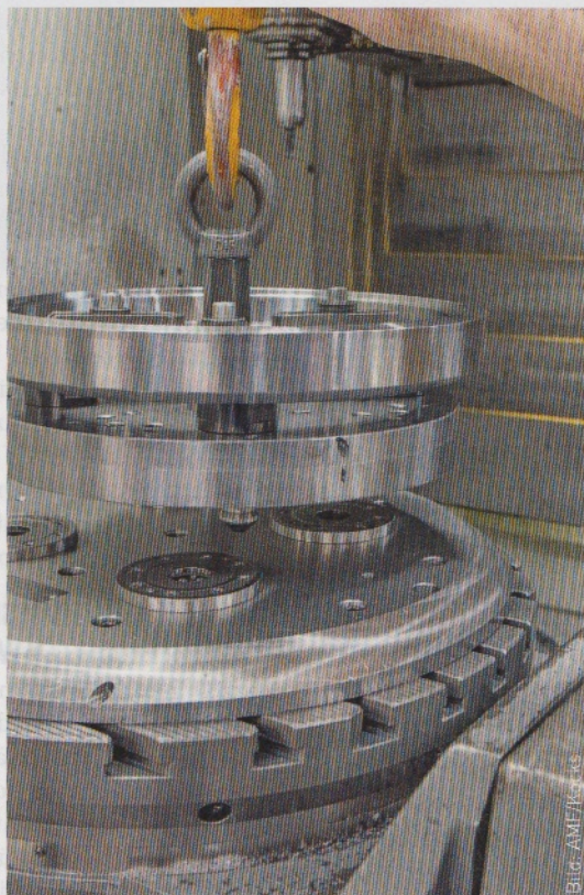
Weil mit der AMF-Nullpunktspannung so einfach umgespannt werden kann, können hier ungeplante und eilig zu fertigende Ersatzteile problemlos in den Fertigungsablauf eingeschoben werden.
