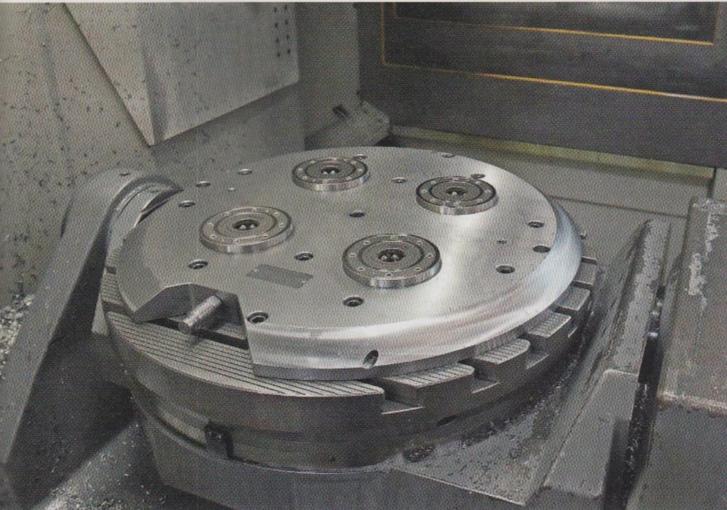
Auf der DMG-Maschine macht sich die durch das AMF-Nullpunktspannsystem K20 gewonnene Flexibilität besonders bemerkbar. Bild: AMF
