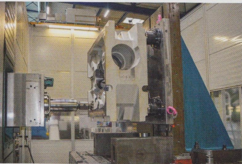
Auf dem riesigen Union Bohrwerk für die Schwerzerspannung kommen die extrastarken AMF-Module K40-H für die Werkstückdirektspannung zum Einsatz.
