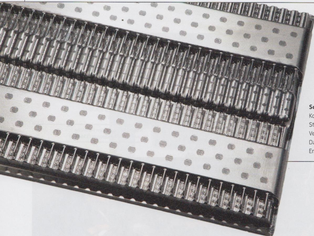
**Schäumwerkzeug:** Die Kompetenz liegt in der Strömungslehre und Verdüsung. 150 Grad heißer Dampf schäumt das Endprodukt auf. (© Keiels)
