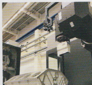
Optisch messende 3D Kamera in der Frässpindel zur Prozessdatenermittlung vermisst einen Motorblock.
