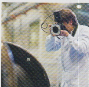
Vermessung zur Ermittlung der Rohteilgeometrie durch Fotogrammetrie.
