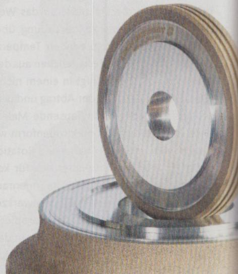
Lach Diamant zeigt auf der GrindTec „contour-profiled“-Profilschleifscheiben für Metallbinder. Benötigt die kunstharzgebundene Schleifscheibe beim Tiefschleifen von Bauteilen aus Hartmetall, hochlegierten Stählen oder Keramik bis zu drei Arbeitsgänge, erledigt die metallgebundene „contour-profiled“-Profilschleifscheibe laut Hersteller dies in einem Durchlauf.
