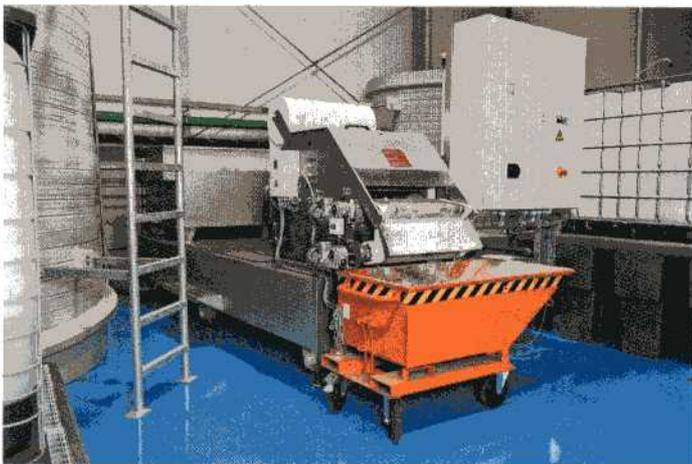
Die Vorfilterstation UF 700 ist ein hydrostatisch arbeitender Schrägbettfilter mit einem 4.000 Liter großen Edelstahl-Auffangbehälter. Der abgeschiedene Filtrationskuchen kann über einen kippbaren Schlammwagen bequem ausgebracht werden.
