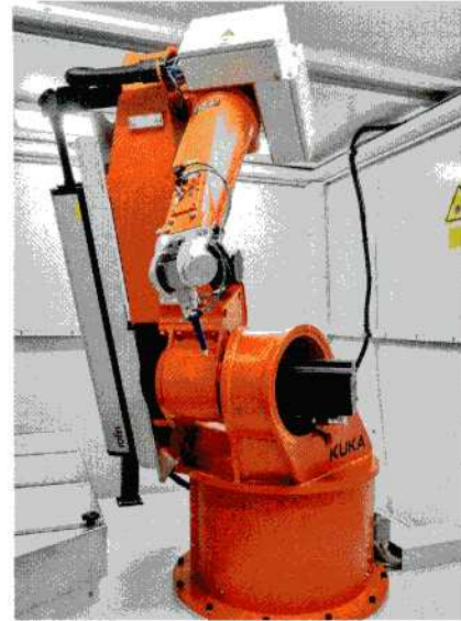
Mit integrierter Strahlführung: CO 2 -Laserroboter vom Typ RV6/16L-CO2 (© Kuka Industries)
